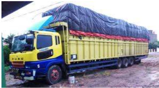
Gambar 2: Kendaraan beban lebih dengan konfigurasi beban sumbu
