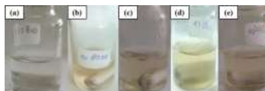
Gambar 1. Tinta konduktif tanpa penambahan etilen glikol (a), dengan penambahan etilen glikol 10% (b), penambahan etilen glikol 20% (c), penambahan etilen glikol 30% (d) dan penambahan etilen glikol 40% (e).
