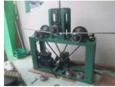
Gambar 2. Alat Roll Besi
