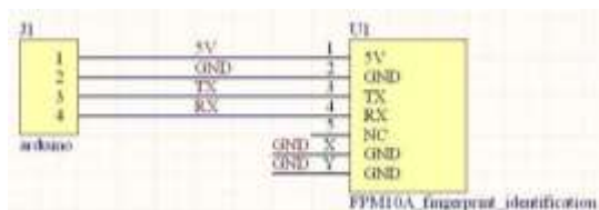
Gambar 5. Skema hubungan FPM10A dengan Mikrokontroler
