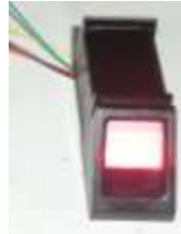
Gambar 4. Modul sensor sidik jari FPM10a
