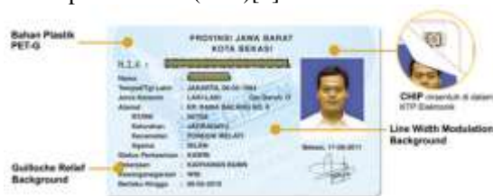
Gambar 2. Contoh e-KTP dengan contactless chip di dalamnya
